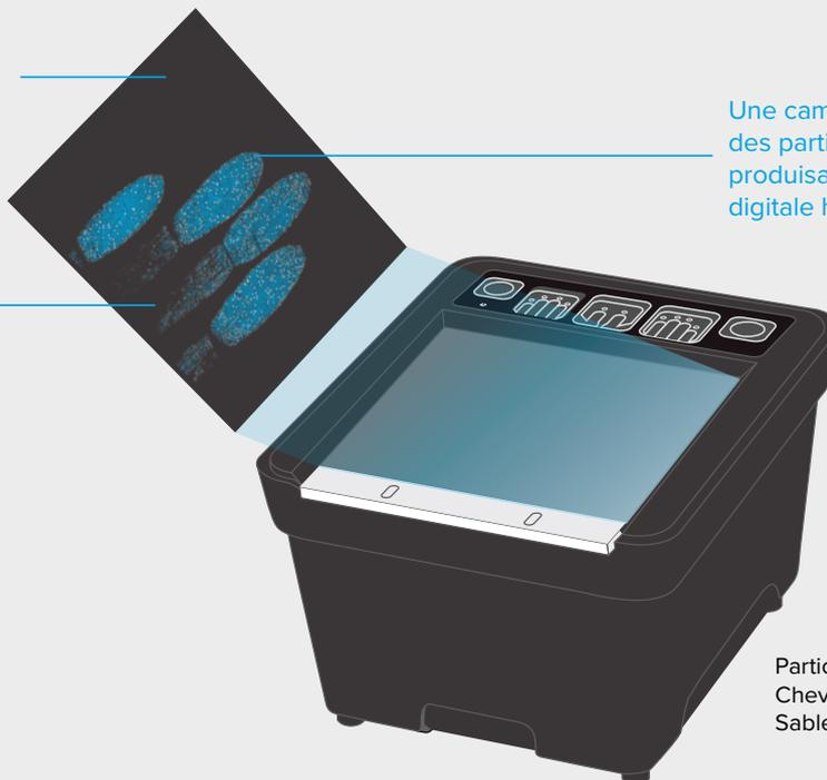
Une caméra CMOS capte la lueur des particules de phosphore produisant l'image d'une empreinte digitale haute résolution.
